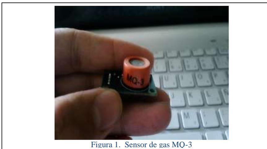
Figura 1. Sensor de gas MQ-3
