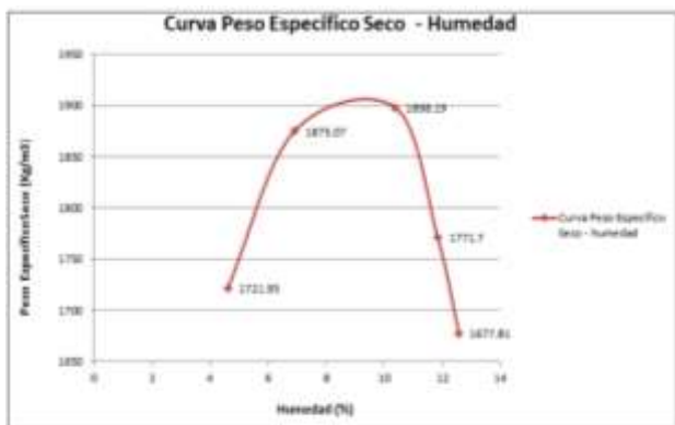
Gráfica 1. Curva Peso Específico Seco Máximo – Humedad para el Sahcab
