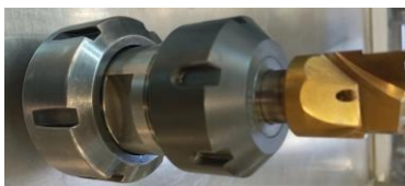
Figura 2. C-bore, herramienta usada para el maquinado de la copa.
