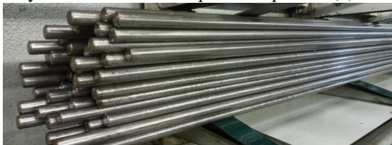
Figura 1. Material en barra redonda, acero AISI/SAE C12L14.
