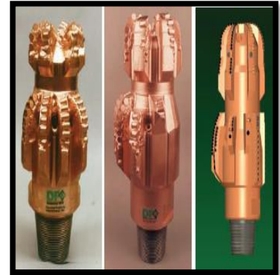
Figura 5.- Barrena especiales, ampliadoras o bicéntricas son utilizadas para operaciones tales como ampliación del diámetro del agujero de superficie o alguna profundidad determinada.
