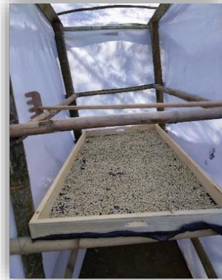
Figura 3. Módulo protegido para el secado de café en pergamino, en operación.
