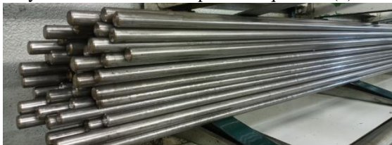
Figura 1. Material en barra redonda, acero AISI/SAE C12L14.
