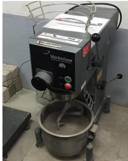
Figura 1. Mezclado mecánico del mortero
