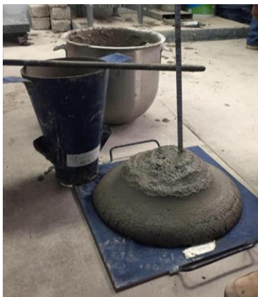
Figura 2. Revenimiento del mortero
