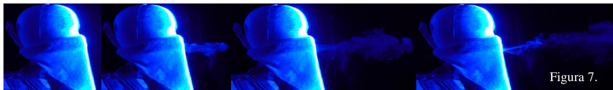
Figura 7. Atomización de aerosoles respiratorios con “cubrebocas casero” de tela de algodón doble.
