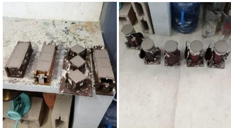
Figura 3. Elaboración de cubos y cilindros
