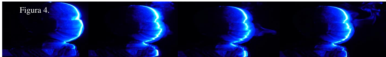
Figura 4. Atomización de aerosoles respiratorios con cubrebocas tricapa.
