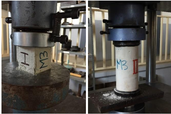
Figura 4. Cubos y cilindros sometidos a compresión
