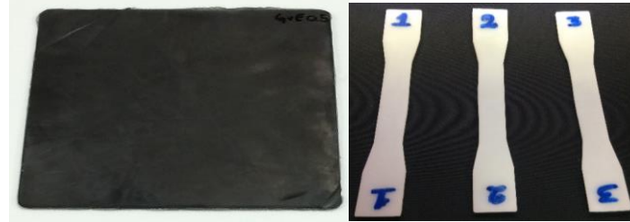
Figura 2. Placas de material muestra Topas vs UHMWPE
