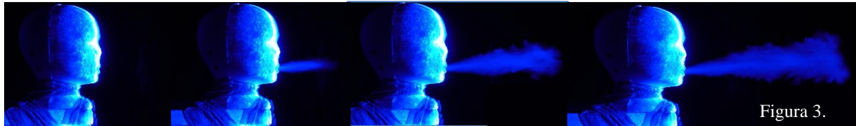
Figura 3. Atomización de aerosoles respiratorios sin cubrebocas.
