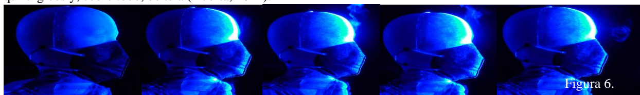
Figura 6. Atomización de aerosoles respiratorios con mascarilla de alta eficiencia KN95.
