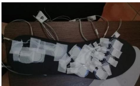
Figura 1 Plantilla incorporando sensores FSR 150kg
