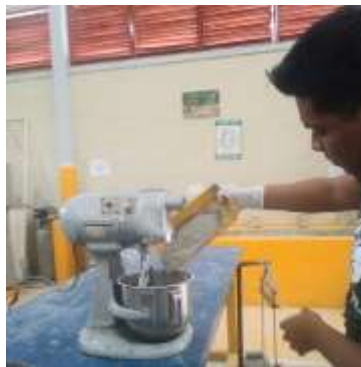
Figura 4. Elaboración de morteros
