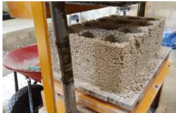
Figura 3. Elaboración de bloques
