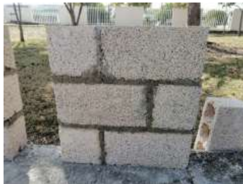
Figura 7. Levantamiento de MBP de 60x60 cm
