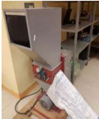
Figura 2. Trituración y recolección de las botellas de PET
