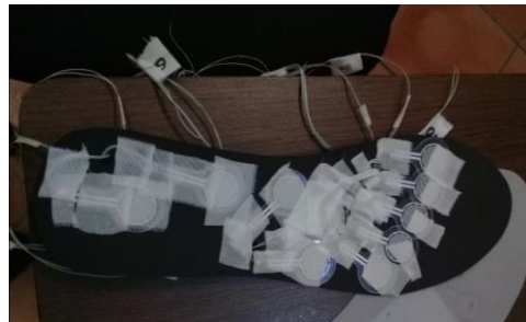
Figura 1 Plantilla incorporando sensores FSR150kg
