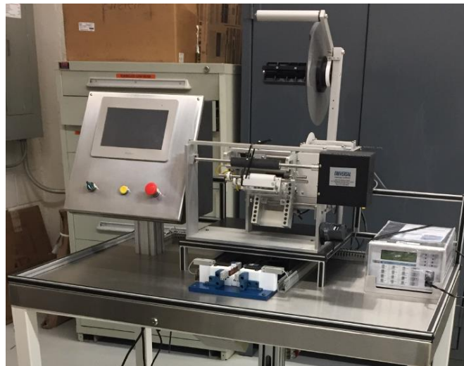
Figura 8. Estación de prueba y etiquetado de fusible
