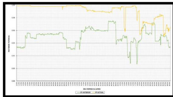
Fig. 7. Factor de potencia antes y despues de la operacion del filtro activo
