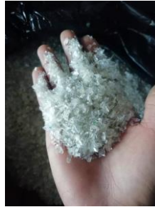
Fotografía 1. Agregado PET en hojuela de tamaño aproximado de \frac{3}{8} de pulgada.
