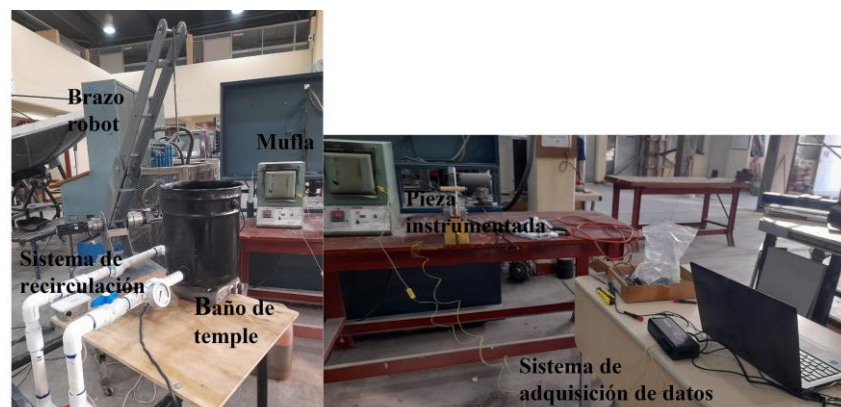
Figura 2.- Equipos utilizados en la instrumentación y tratamiento térmico de temple controlado.
