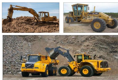
Figura 1. Excavadora, motoniveladora, pala cargadora y camión de volquete. Fuente: Pavimentos (2014).
