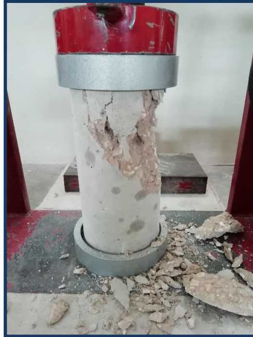
Figura 4. Prueba de compresión
