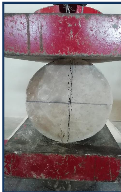
Figura 5. Prueba de Resistencia a la tracción indirecta
