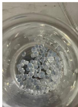
Figura 1.5 Esferas de hidrogel obtenidas en la tercera práctica
