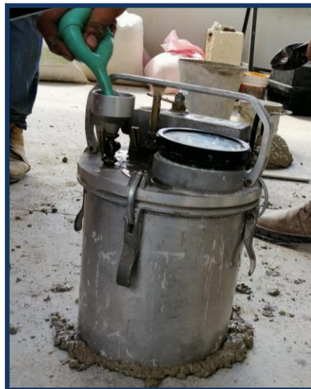
Figura 3. Prueba contenida de aire
