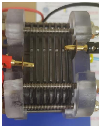
Figura 1. Celda de combustible con escalamiento a 7 ensambles membrana/electrodos.
