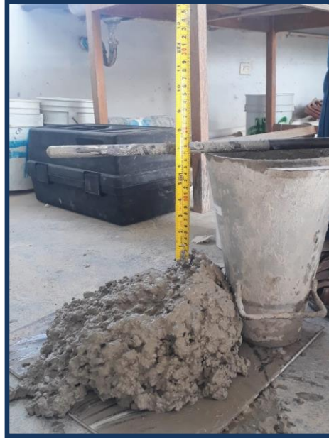
Figura 2. Prueba de Revenimiento
