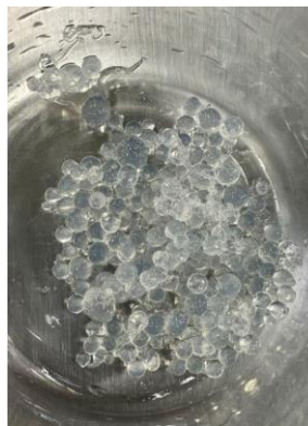
Figura 1.6 Más esferas de hidrogel obtenidas en la tercera práctica
