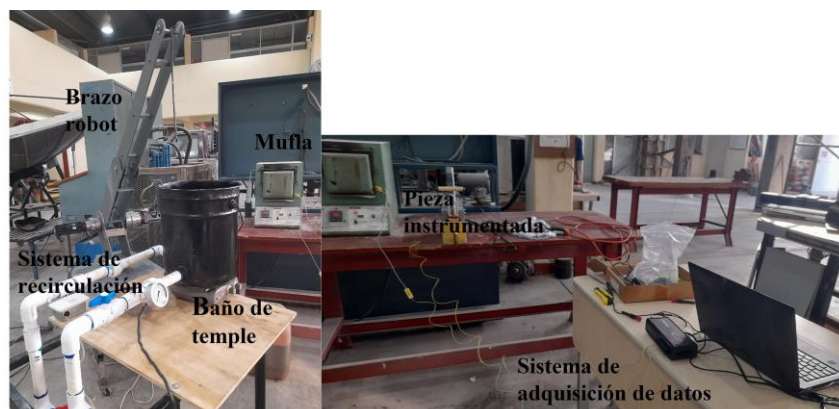
Figura 2.- Equipos utilizados en la instrumentación y tratamiento térmico de temple controlado.
