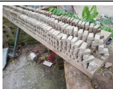
Figura 8-Morales y Quintero -Proceso de elaboración de los ladrillos, Diseño y construcción de bóvedas catalanas para edificación de viviendas sustentables, 2021
