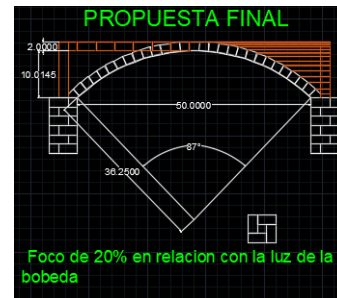
Figura 6-Morales y Quintero -Geometrización de la bóveda de arista, Diseño y construcción de bóvedas catalanas para edificación de viviendas sustentables, 2021
