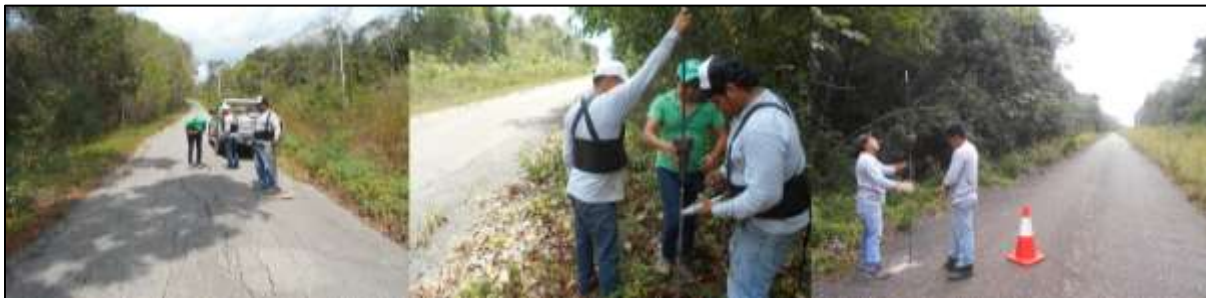
Figura 4. Exploración aplicando el cono dinámico de penetración
