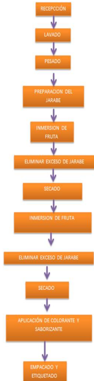
Figura 3. Diagrama de flujo del proceso de confitado
