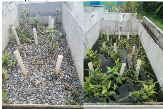
Figura 1. Preparación de los HAFS y HAFL experimentales con Ludwigia octovalvis con método tres bolillos.
