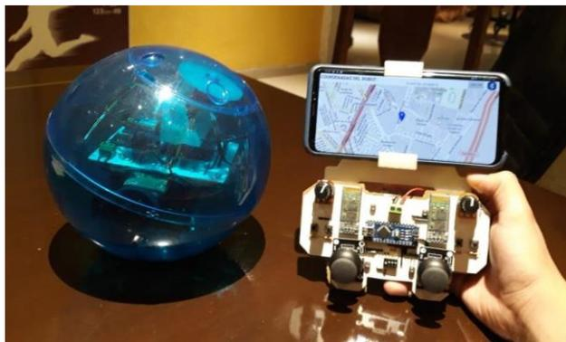
Figura 1. Robot Bot y control del robot.
