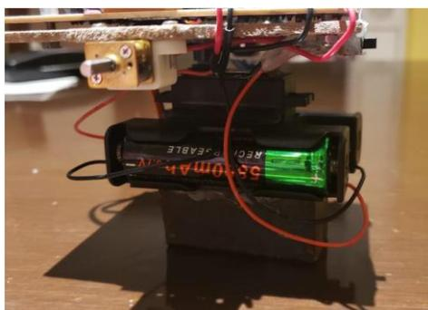
Figura 3. Sistema de alimentación de Robot Bot.
