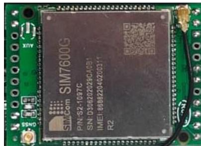
Figura 4. Módulo *4G/LTE* usado para el desarrollo del prototipo.
