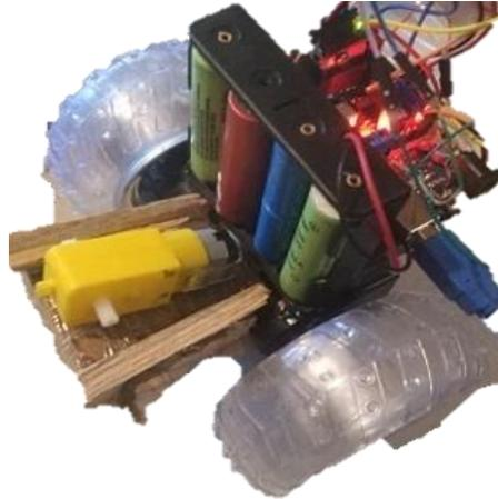
Figura 3. Prototipo de robot péndulo invertido 2 ruedas
