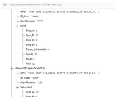
Figura 7. Base de datos desarrollada en *Firebase* con los datos enviados recabados del *Jetta Hybrid*.
