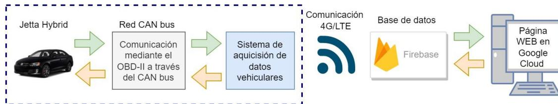
Figura 6. Esquema a bloques de los componentes involucrados en la prueba de envío de datos vehiculares.
