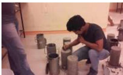
Fig. 4.- descimbrado y etiquetado de cilindros
