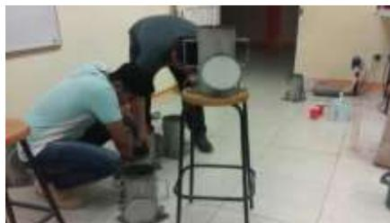
Fig. 3.- Elaboración de cilindros de concreto
