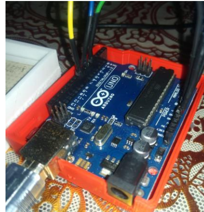
Figura 10. Jumpers conectados a la placa arduino UNO.
