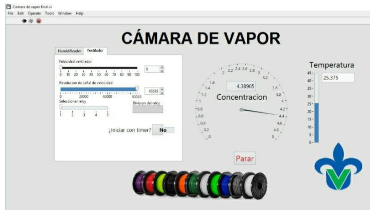
Figura 12. Interfaz del programa controlador de la cámara de vapor de acetona con humidificador ultrasónico.
