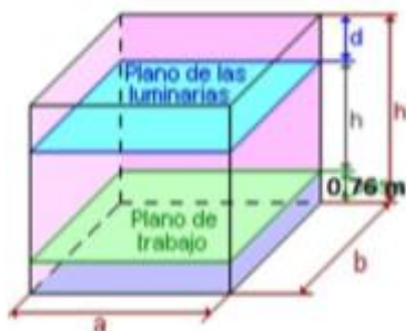
Imagen 1. Dimensiones a tomar en cuenta para el cálculo de flujo luminoso
