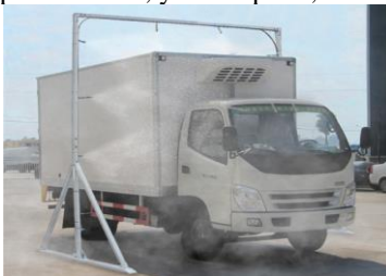
Figura 1.- Desinfección de superficies vehiculares (Arco desinfectante para vehículos GEMA-PRO)
