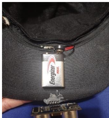
Ilustración 3 montaje batería de 9V
