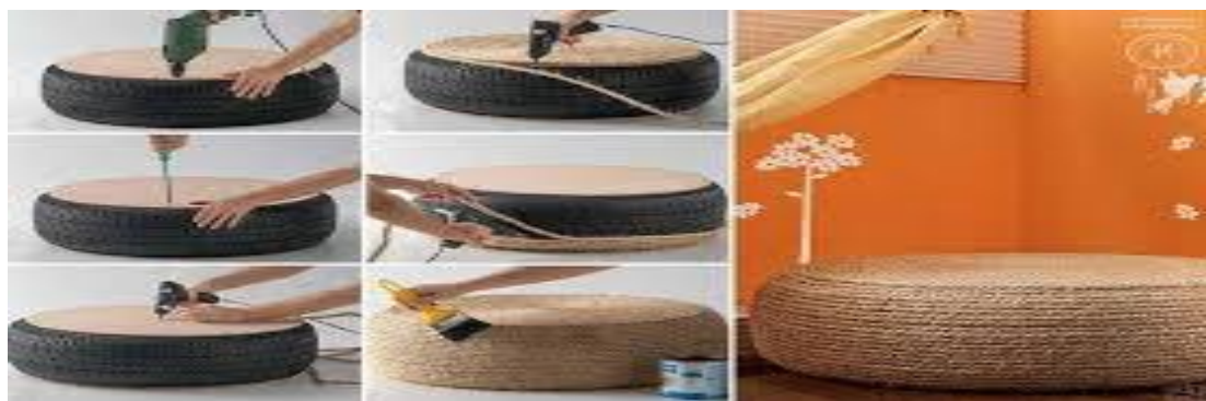
Figura 1. Proceso de elaboración del taburete, haciendo uso de llantas recicladas
