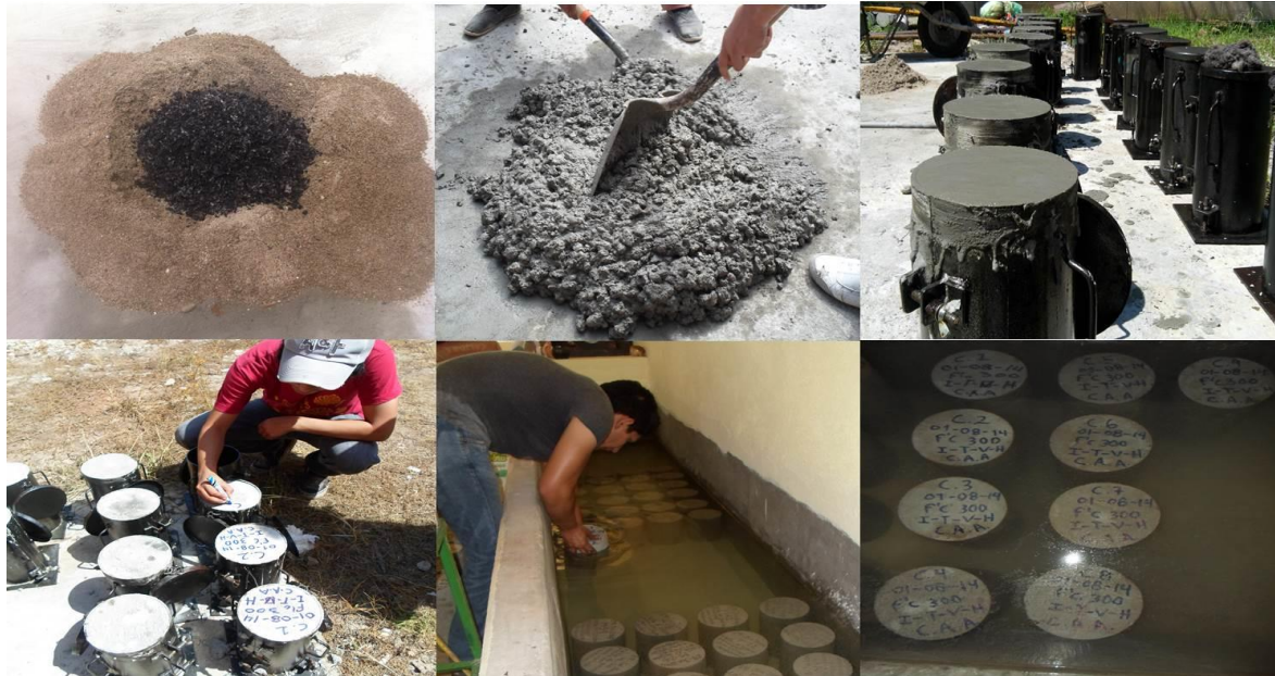
Figura 2. Colado, prueba de revenimiento y cimbrado de cilindro con un f'c = 300\text{kg/cm}^2 Rotulado, descimbrado y curado de los cilindros
