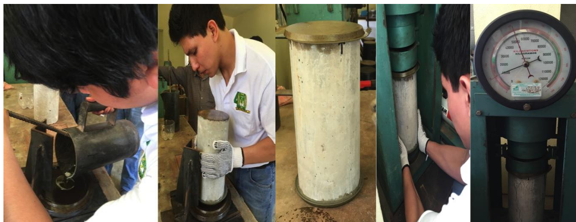
Figura 3. Cabeceo y prueba de resistencia a los cilindros.
