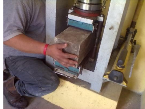
Figura 2.- colocando la viga para someterla a esfuerzos de flexión.
