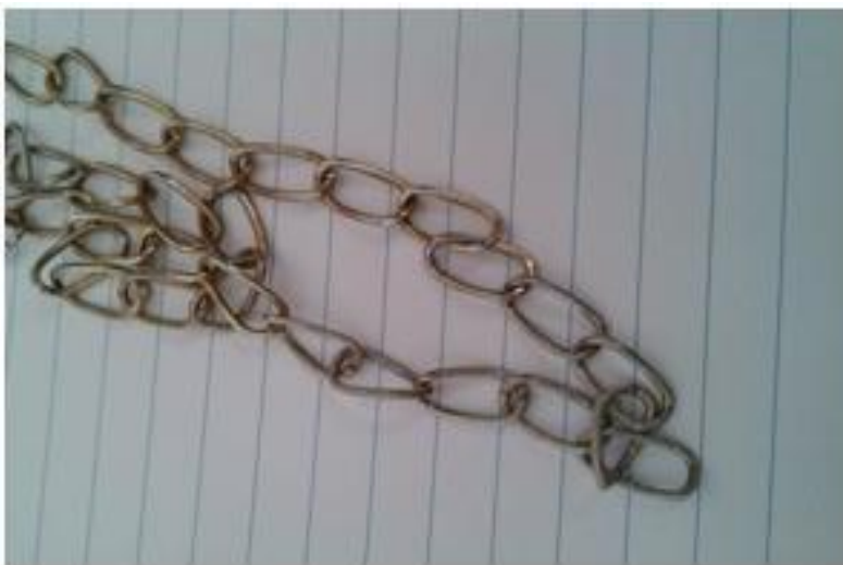
Figura 3. Collar recubierto de plata a partir de la solución electrolítica por aplicación de 0.73 V, 0.1 A y 1 min de exposición.
