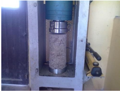
Figura 1.- sometiendo un cilindro a esfuerzos de compresión.
