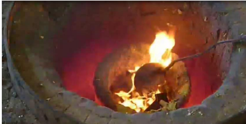
Figura 2. Crisol de barro para fundición.
