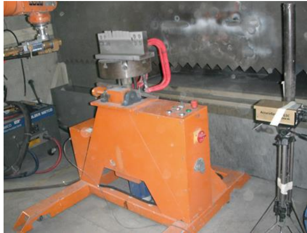
Figura 2. Equipo de medición de velocidad y temperatura de la partícula Accura spray
