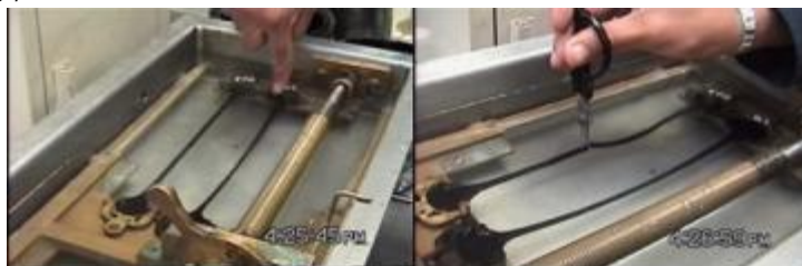
Figura 7. Reposo de las muestras de asfalto elongadas y corte en el centro de las mismas
