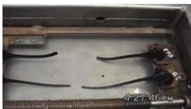
Figura 8. Recuperación de ambas muestras de asfalto cortadas
