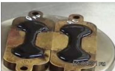
Figura 3. Muestras de asfalto enfriándose a temperatura ambiente
