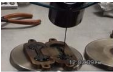
Figura 2. Vaciado del asfalto en los moldes para realizar la prueba
