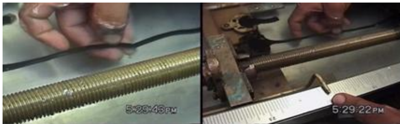
Figura 5. Retiro de piezas laterales de las briquetas y muestras de asfalto en el ductilómetro previo a correr la prueba
