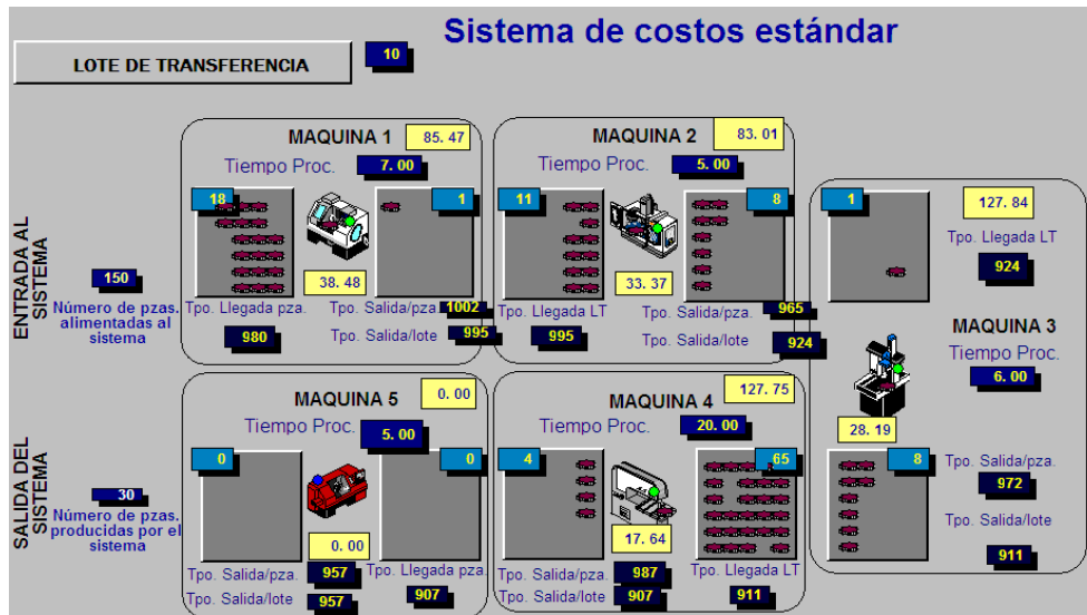
Figura 3. Representación del layout del sistema de manufactura, bajo estudio, funcionando bajo el enfoque del SCE.
