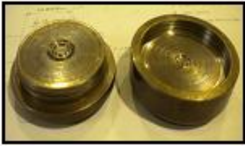
Figura 8. Molde actual (izquierda) y multimolde (derecha) del empaque oring 6x2 pulg., (alternativa 2)
