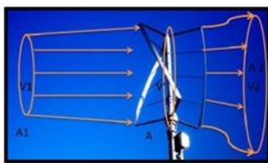
Figura 3.- Desviación del viento por el aerogenerador vertical
