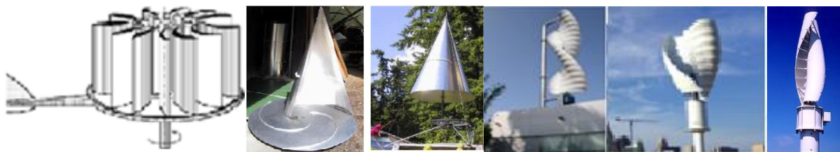
Figura 2.- Savonius con difusor, turbina de velas y cónica, tipo Windside y tipo WS-0,15
