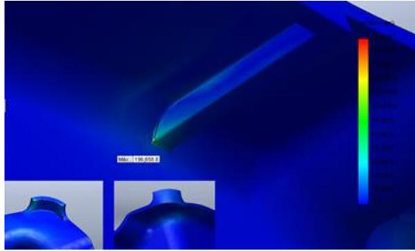
Figura 5. Distribución de esfuerzos en la parte de sujeción del cajón convencional.
