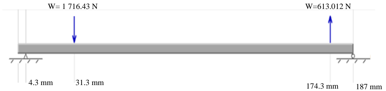
Figura 2. Diagrama de cuerpo libre del eje intermedio.
