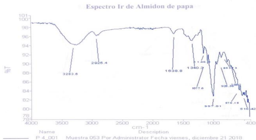
Imagen: figura 1,, Espectro IR del almidón obtenido (muestra 2) Elaboración propia
