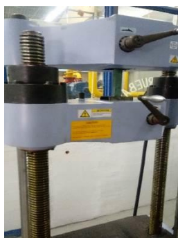
Figura 8 probeta instalada en la Maquina universal de ensayes SHIMADZU
