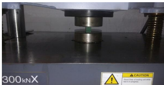
Figura 1 probeta del material de NECURON 1001 instalada en la maquina universal SHIMADZU
