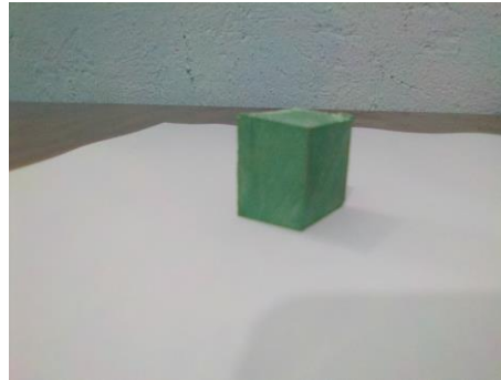
Figura 4 probeta del material de NECURON 1001 antes del ensaye de compresión
