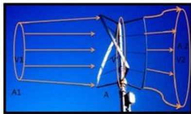
Figura 3.- Desviación del viento por el aerogenerador vertical
