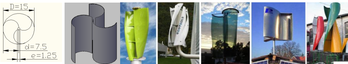
Figura 1.- Aletas en forma de eje vertical con rotor Savonius
