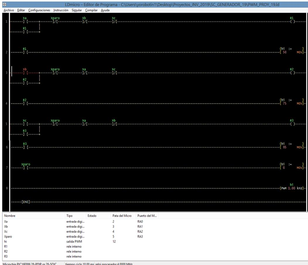
**Figura 6.** Programa de control en Lenguaje Escalera del Generador de Energía
