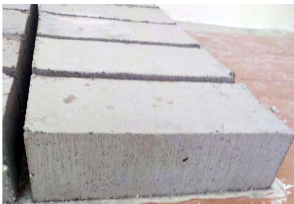
Figura 2.0 – Piezas prismáticas dolomita con sal epsom
