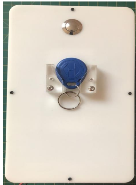
Figura 3. Aspecto físico del control de energía con su llavero RFID.
