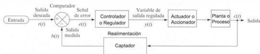
Figura 3. Diagrama de bloques de un sistema de control en lazo cerrado
