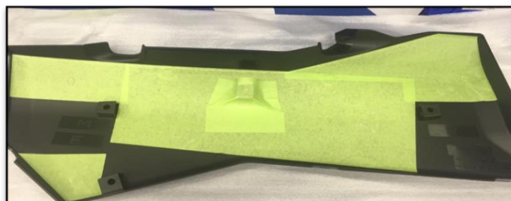
Ilustración 3 Representación real de la pieza Rear Door del vehículo Can-Am X3 Maverick con cinta para enmascarar.
