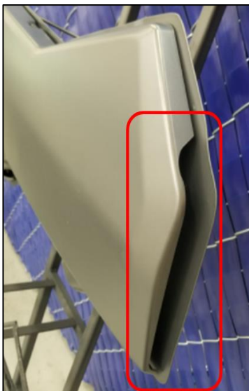
Ilustración 5 vista lateral de zonas que presentaron problemas en la segunda prueba de pieza plástica Rear Door
