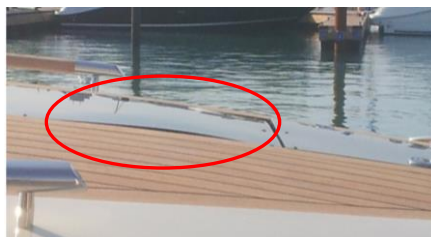
Figura 2. Deformación de la lámina con la exposición al calor.
