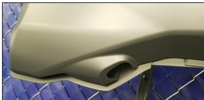
Ilustración 6 vista inferior de zonas que presentaron problemas en la segunda prueba de pieza plástica Rear Door
