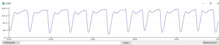
Figura 8 Señal de PPG obtenida al medir sobre el empeine (arteria dorsal).
