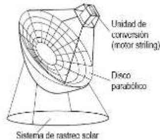
Figura 1. Esquema de un sistema disco/Stirling.
