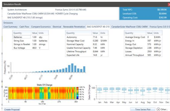
Fig. 7. Operación de banco de baterías en sistema óptimo
