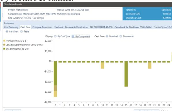
Figura 4. Flujo de efectivo sistema óptimo, HOMER PRO.
