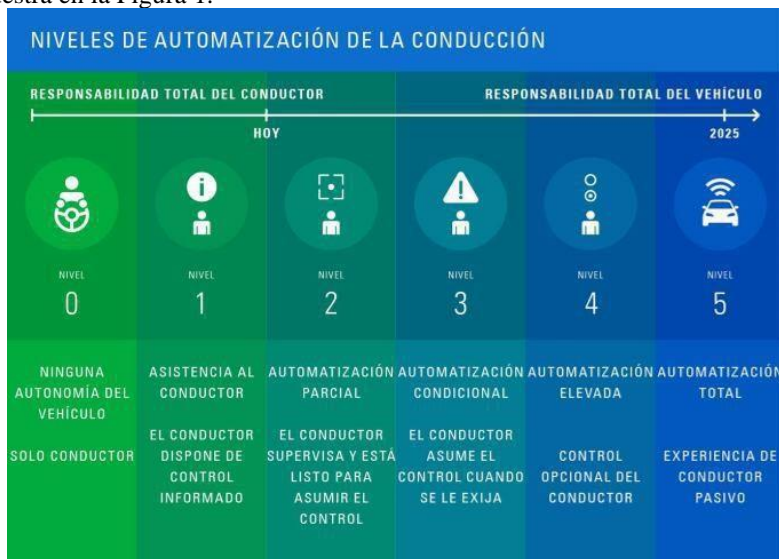
Figura 1. Niveles de autonomía en la conducción Fuente: (tuv-sud,2020).
