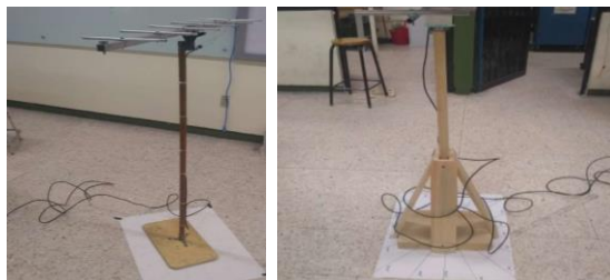
Figura 8. Antena construida y hoja para generar el patrón de radiación.
